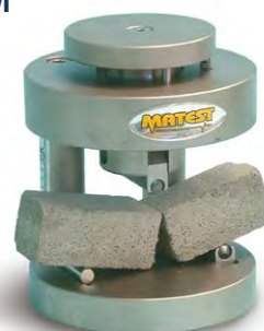
E172-01 ПРИСПОСОБЛЕНИЕ ДЛЯ ИЗГИБА ЦЕМЕНТНЫХ БАЛОЧЕК 40,1X40X160 MM
