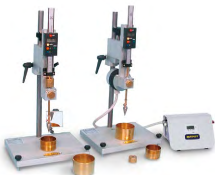
S165-02 KIT КОНУСНЫЙ ПОЛУАВТОМАТИЧЕСКИЙ ЦИФРОВОЙ ПЕНЕТРОМЕТР
