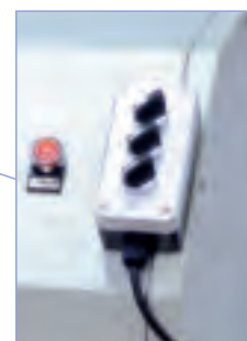
Стандартная модель, только низкое давление зажима (3 кнопки)
