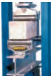
Сжатие образцов бетона
