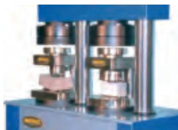
Растяжение при расколе бетонных кубов и цилиндров
