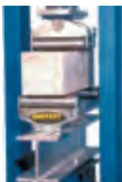
Сжатие образцов бетона
