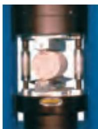
Изгиб образцов бетона
