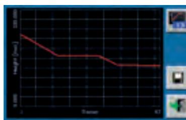
Уплотнение с контролем нагружения, по prEN 12697-33 7.2 Приложение A и TP Асфальт
